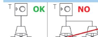
Un termostato può comandare un solo motore tipo M/P (a 3 fili)
