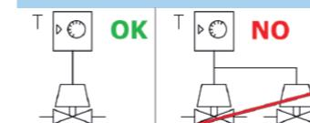
Un termostato può comandare un solo motore tipo M/P (a 3 fili)
