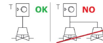
Un termostato può comandare un solo motore **tipo M/P** (a 3 fili)
