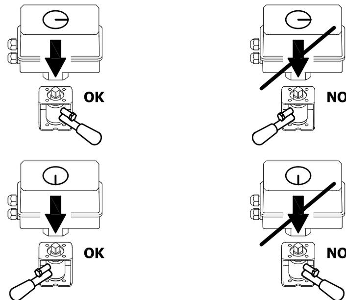
Grazie all'attacco quadro, è possibile montare il servomotore sul distanziale anche con il servomotore ruotato di 90° / 180° / 270° rispetto a come sopra raffigurato; prestare sempre attenzione alla compatibilità delle relative posizioni prima dell'accoppiamento.
