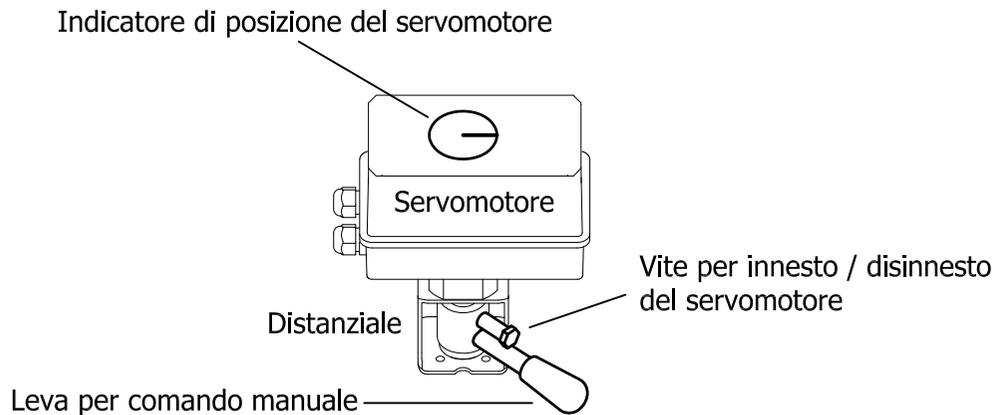
Per manovrare la valvola con il servomotore, avvitare completamente la vite.
