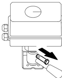
Nel caso la vite fosse difficile da svitare, utilizzare una chiave da 15 e / o manovrare il servomotore avanti e indietro fino a poter muovere la vite. Togliere tensione al servomotore quando si opera manualmente.
